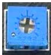
Trimmer para ajuste do contraste do display LCD
