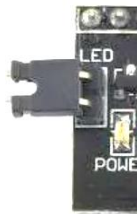
Controle da luz de fundo (backlight) do visor do display
